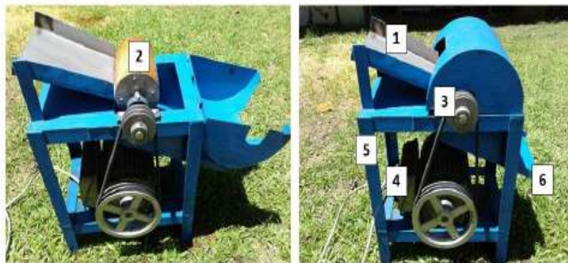
Keterangan: (1) hopper, (2) silinder, (3) pulley silinder, (4) motor listrik, (5) rangka utama, (6) bagian pengaliran hasil parutan
