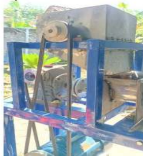
Gb. 2.1 Mesin parut kelapa motor listrik 145 Watt, Kapasitas 20 Kg/jam. (Referensi : Jurnal Ahmad Adi Nugroho, Fatkur Rhohman-2022)
